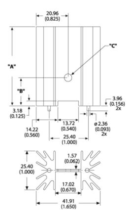
A Dim **38.10**B Dim **21.59**C Dim **3.66**
